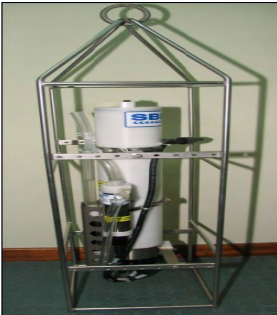
Εικόνα 2.3: Συσκευή συνεχούς καταγραφής αβιοτικών παραμέτρων της υδάτινης στήλης (CTD). (πηγη: Α. Λόλας).
