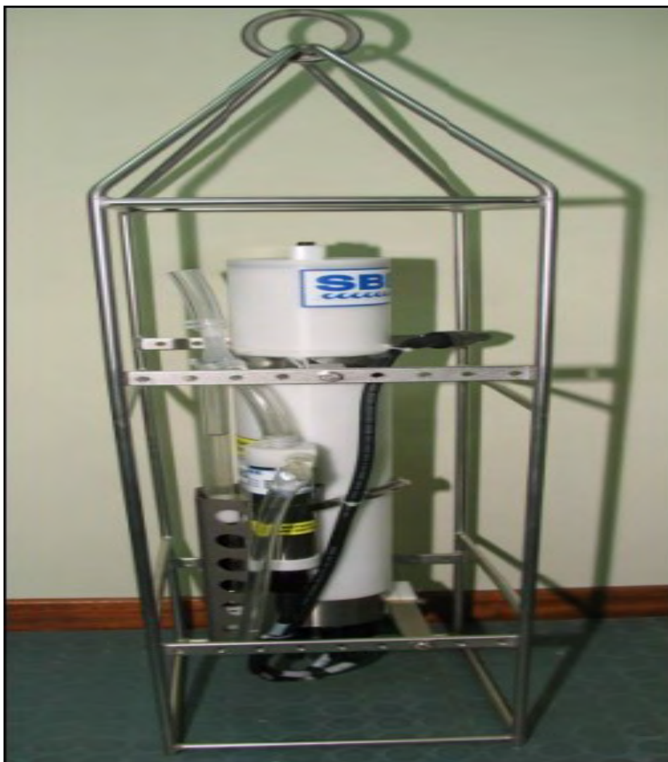
Εικόνα 2.3: Συσκευή συνεχούς καταγραφής αβιοτικών παραμέτρων της υδάτινης στήλης (CTD). (πηγή: Α. Λόλας).
