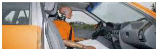
Δοκιμή πρόσκρουσης IX με ανθρώπινο προσομοίωμα
