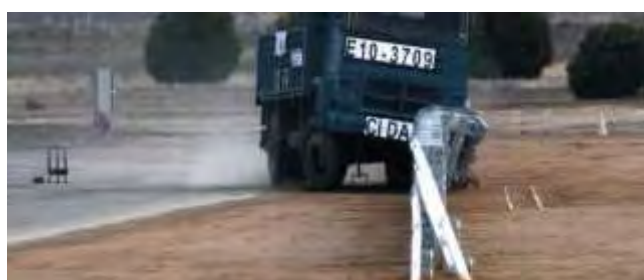
Δοκιμή πρόσκρουσης φορτηγού σε μεταλλικό στηθαίο ασφαλείας
