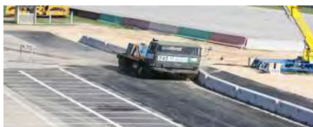
Δοκιμή πρόσκρουσης φορτηγού σε στηθαίο ασφαλείας σκυροδέματος
