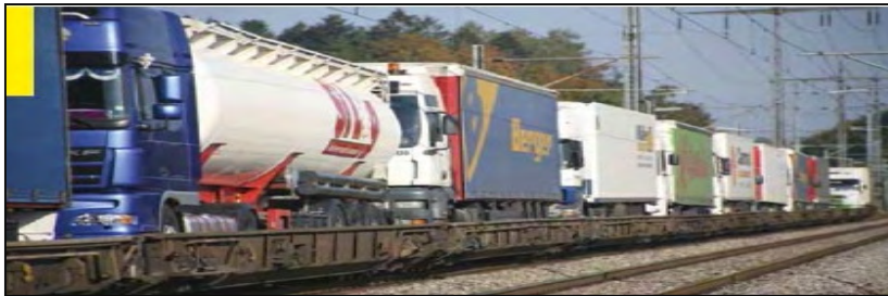
Εικόνα 1.1: Rolling Road ή/και Rollende landstrasse RO-LA (Αδαμαντιάδης Μ., 2007)
