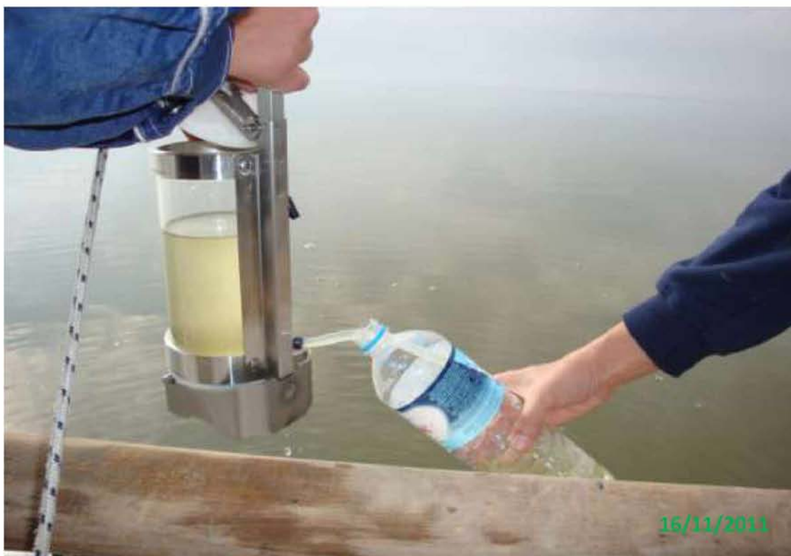
Εικόνα 2.2: Δειγματολήπτης νερού (Limnos Rossincatu 2 E 17 20380 Turku Finland)
