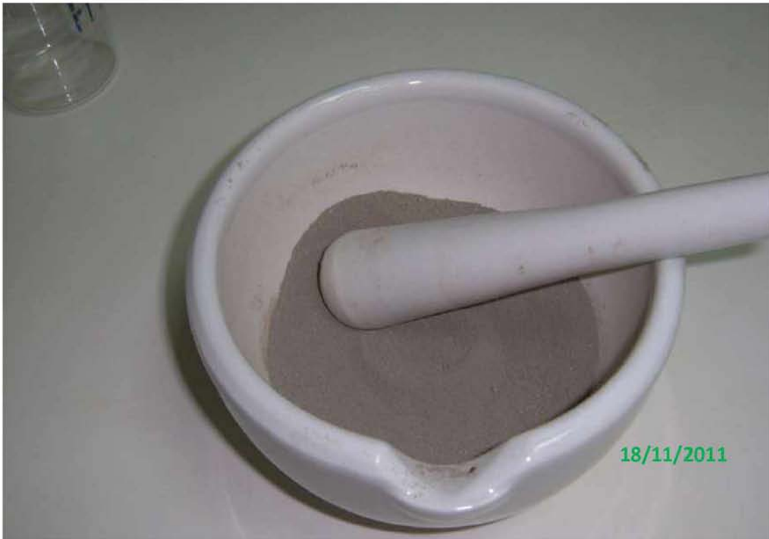
Εικόνα 2.9: Κονιορτοποίηση ιζήματος σε γουδί πορσελάνης.
