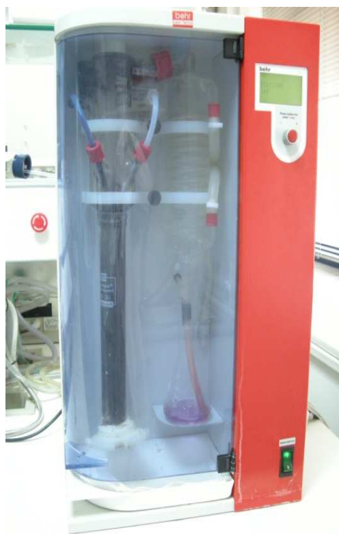
Εικόνα 2.9: Συσκευή Kjeldahl εν ώρα λειτουργίας, με εμφανή την αλλαγή χρώματος στην οποία υποβλήθηκε το βορικό αμμώνιο, στην κωνική φιάλη. (Πηγή: Προσωπικό αρχείο)
