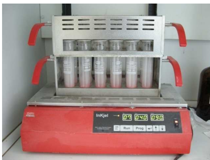
Εικόνα 2.6: Συσκευή πέψης για μετατροπή του αζώτου σε αμμωνιακά άλατα. (Πηγή: Προσωπικό αρχείο)
