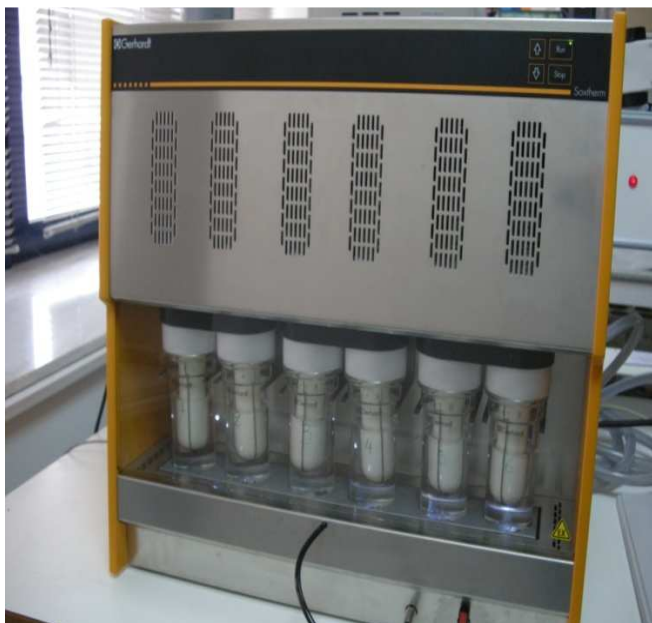
Εικόνα 2.2: Συσκευή Soxtec στην οποία έχουν τοποθετηθεί τα δείγματα με τα γυάλινα δοχεία εκχύλισης. (Πηγή: Προσωπικό αρχείο)
