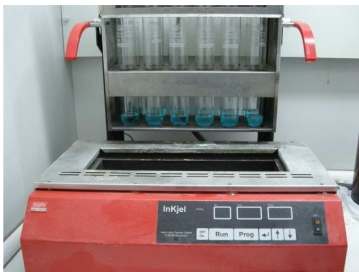
Εικόνα 2.7: Μετά το πέρας της συσκευής πέψης, τα δείγματα αφέθηκαν στη συσκευή δέσμευσης των καπνών. (Πηγή: Προσωπικό αρχείο)
