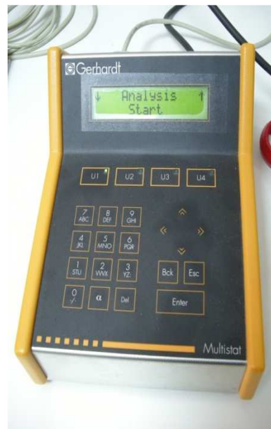
Εικόνα 2.3: Χειριστήριο της συσκευής Soxtec. (Πηγή: Προσωπικό αρχείο)
