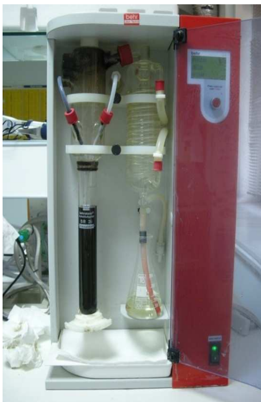
Εικόνα 2.8: Συσκευή Kjeldahl εκτός λειτουργίας. (Πηγή: Προσωπικό αρχείο)
