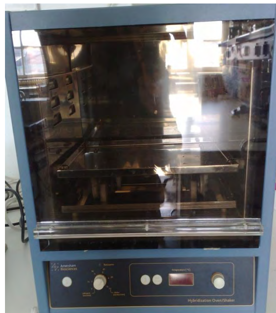
Εικόνα 2.11 Θερμαινόμενος θάλαμος με ικανότητα ανάδευσης
