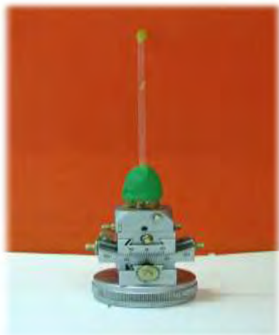
Εικόνα 18 η : Τριχοειδής σωλήνας τοποθετημένος στο γωνιόμετρο.
