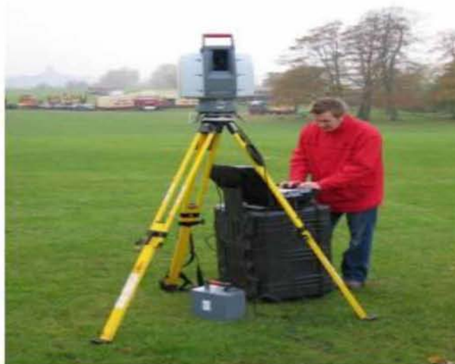
Σχήμα 15: Βασικά μέρη ενός σαρωτή LAZER
