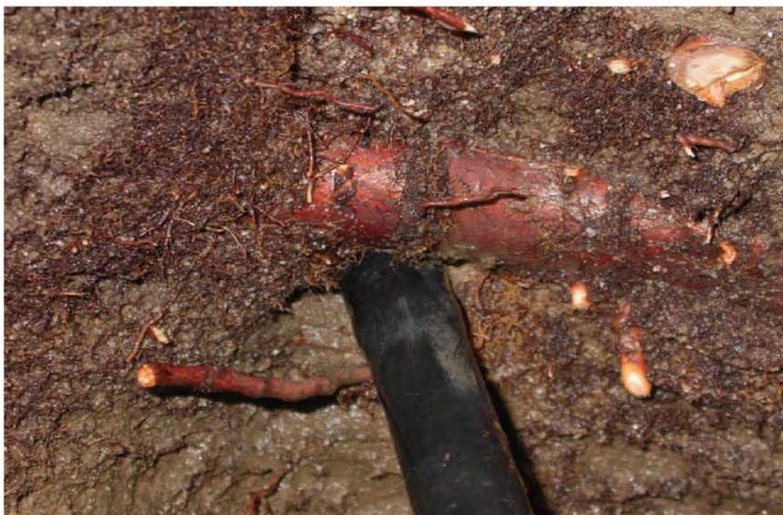
Φωτογραφία 5.2: Συμπίεση πλαστικού σωλήνα υπόγεια στάγδην άρδευσης από ρίζες ροδακινιάς στην Καλιφόρνια των Η.Π.Α. Φωτογραφία T. Trout, USDA-ARS - Καλιφόρνια.
