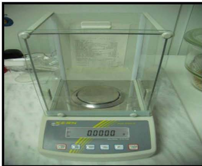
Εικόνα 2.1: Ζυγός ακρίβειας 4 δεκαδικών ψηφίων (Kem ALS 220-4, φωτογραφία συγγραφέα)
