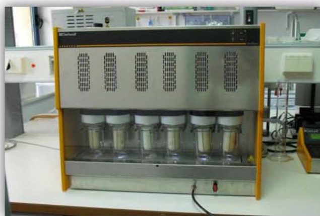
Εικόνα 2.6: Συσκευή εκχύλισης (Soxtherm της Gerhardt, φωτογραφία συγγραφέα).
