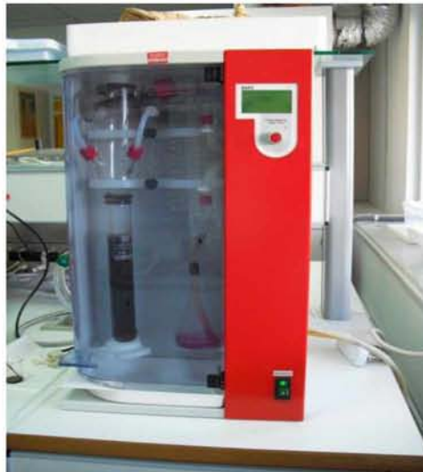
Εικόνα 2.5: Συσκευή απόταξης (Steam Distillation Apparatus S4 της Behr, φωτογραφία συγγραφέα).
