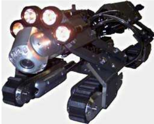
Εικόνα 11: Ρομποτικό όχημα για την εξουδετέρωση εκρηκτικών μηχανισμών.
