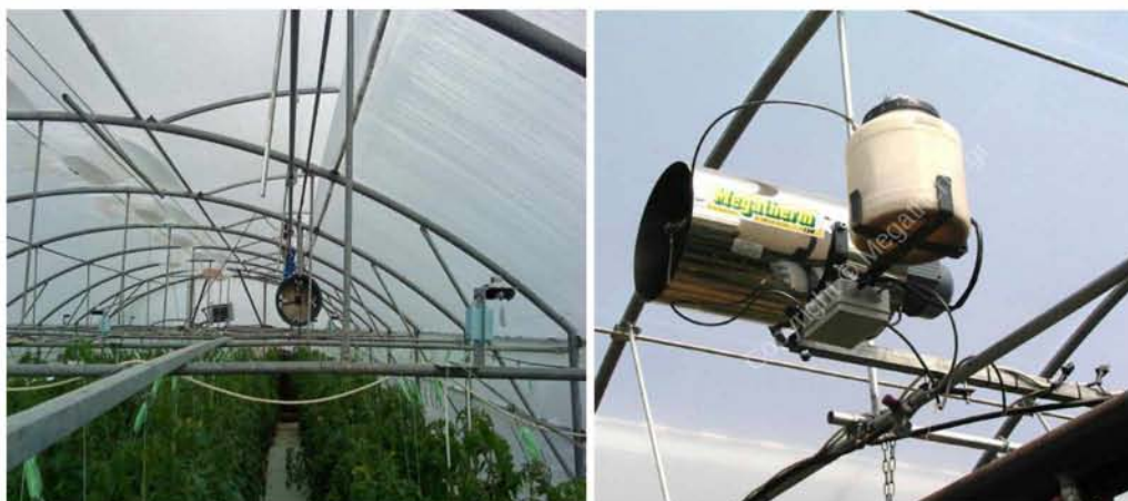
Εικόνα 3.3. Ανεμομίκτης και νεφελοψεκαστήρας στο εσωτερικό του θερμοκηπίου.
