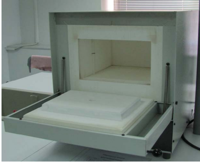
Εικόνα 2.12: Ειδική συσκευή τέφρας – αποτεφρωτήρας. Πηγή: φωτογραφικό υλικό συγγραφέα.
