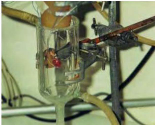
Εικόνα 6. Δοχείο με διπλά τοιχώματα για να προστατεύει και να κρατά σταθερή τη θερμοκρασία της καρδιάς
