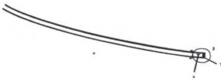
Σχήμα 6. Καθετήρας μέτρησης των πιέσεων. α= άκαμπτος αγωγός, β= μπαλόνι, γ= άκρο κλειστό με σιλικόνη, δ= οπή στην πλάγια επιφάνεια
