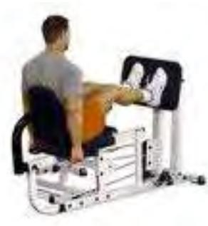
γ) *Iσομετρικό δυναμόμετρο*: Για τη μέτρηση της μέγιστης και εκρηκτικής δύναμης των κάτω άκρων (leg press, σε 90ο γωνία του γονάτου, σε ισομετρικές συνθήκες) (Buhrle, M., 1983).
