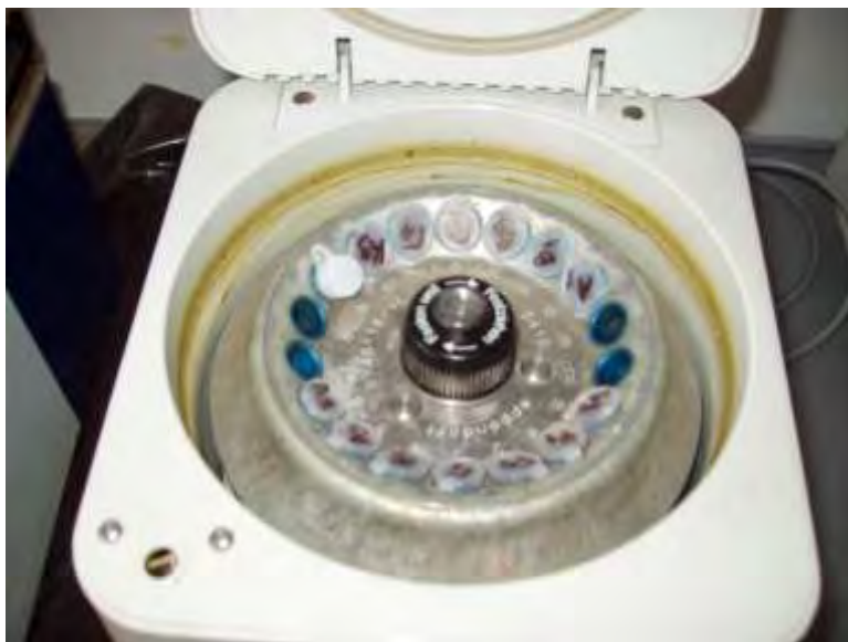
Εικόνα 9.5. Τοποθέτηση των δειγμάτων στην φυγόκεντρο
