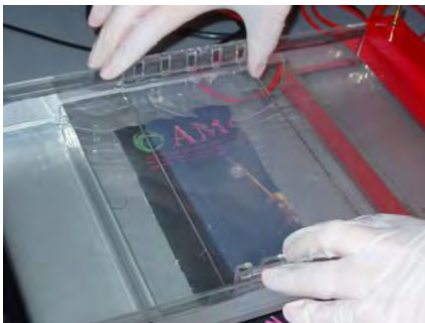
Εικόνα 9.13. Τοποθέτηση του gel στη συσκευή της ηλεκτροφόρησης
