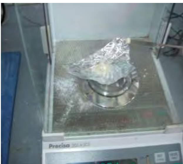
Εικόνα 9.4. Λήψη δείγματος σε ζυγό ακριβείας
