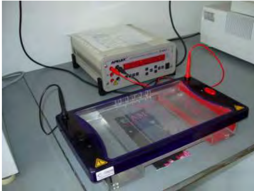
Εικόνα 9.14. Συσκευή ηλεκτροφόρησης σε λειτουργία
