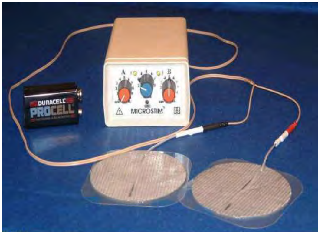
Εικ. 9: Ηλεκτρικός διεγέρτης MS-2 με ζεύγος ηλεκτροδίων και μπαταρία 9V.
