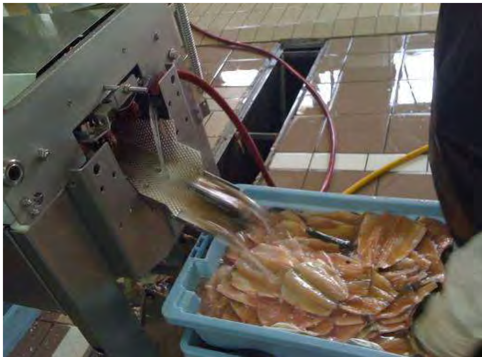
Εικόνες 3, 4. Η έξοδος των φιλέτων από τη μηχανή
