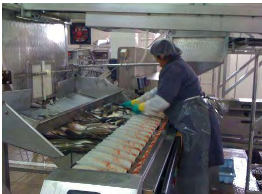
Εικόνες 1, 2. Η τοποθέτηση των ψαριών στις θήκες της μηχανής Baader
