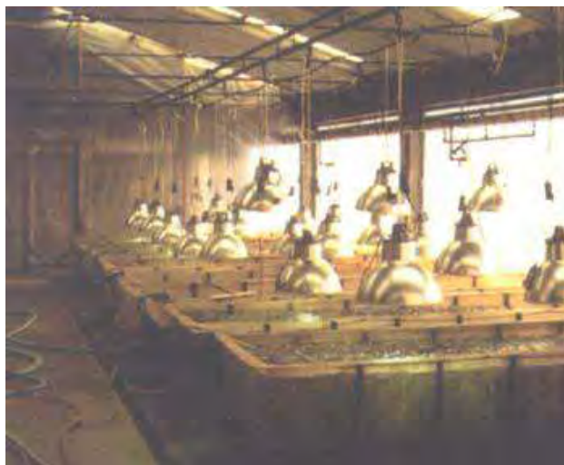
Σχήμα 4.2 – Παλαιού τύπου μονάδα παραγωγής φυκών σε μεγάλη κλίμακα με χρήση τεχνητού φωτισμού
