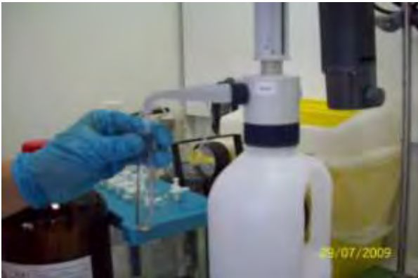
Εικόνα 9: Βήμα 2 και 6 (προσθήκη οξικού αιθυλεστέρα).
