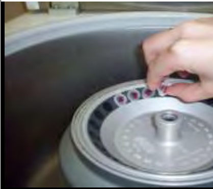
Εικόνα 5: Τοποθέτηση των δειγμάτων του αίματος σε ψυχόμενη φυγόκεντρο για τον διαχωρισμό του πλάσματος.
