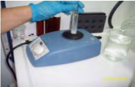
Εικόνα 11: Βήμα 3, 9 και 10 (ανάδευση-vortex).
