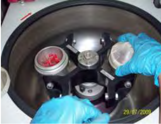
Εικόνα 12: Βήμα 4, 6 και 11 (φυγοκέντρηση).
