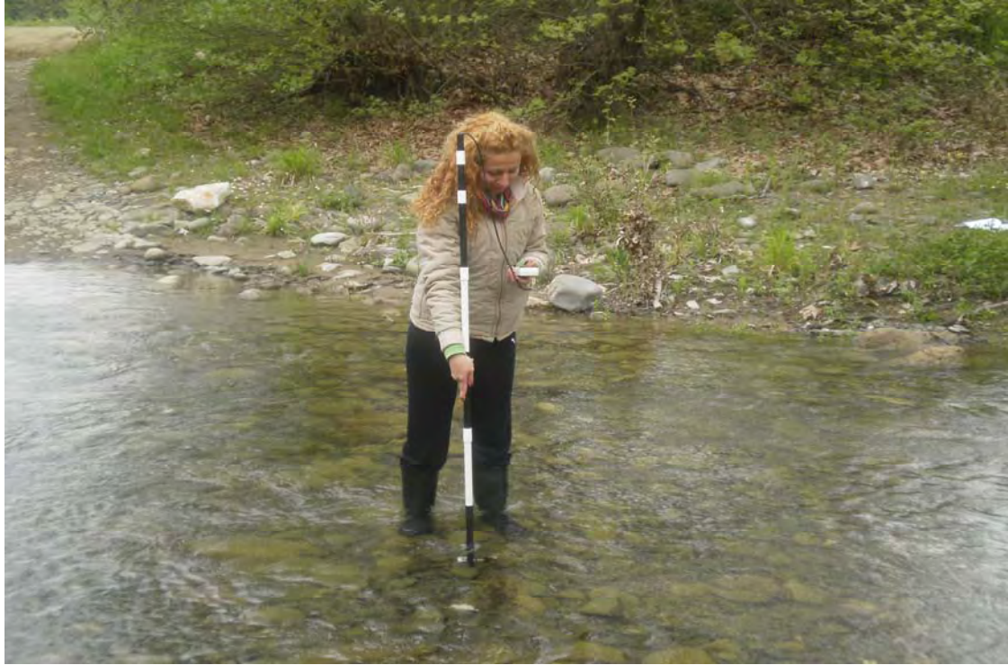
Εικόνα 3: Μέτρηση της παροχής με τη βοήθεια του ροόμετρου στο ρέμα Ρεντινώτης.
