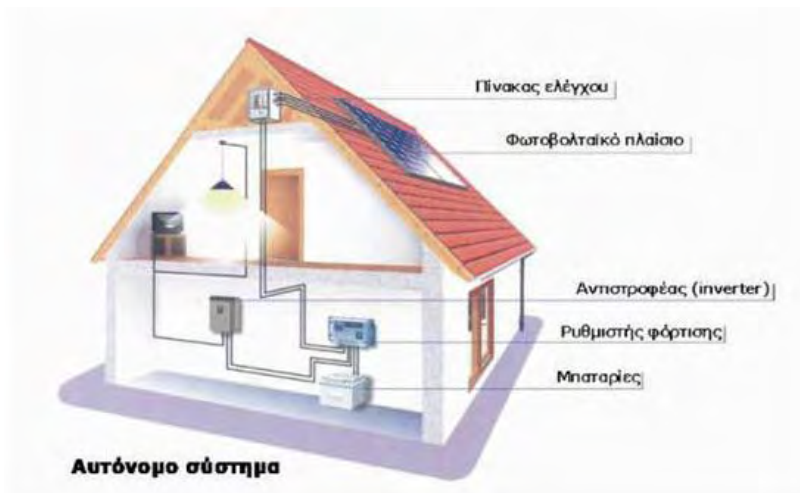
Εικόνα 1.8: Αυτόνομο φωτοβολταϊκό σύστημα.
