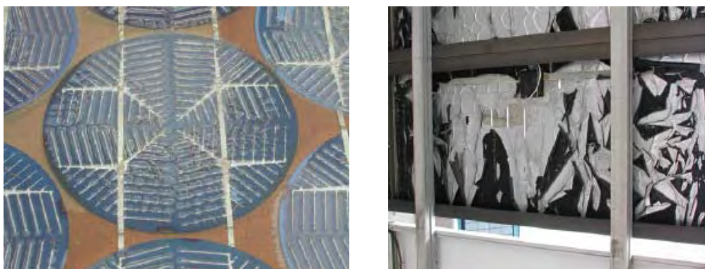
Εικόνα 3.3: (α) Παράδειγμα γήρανσης ΦΒ κυττάρου όπου φαίνεται ο αποχρωματισμός του και το ράγισμα του γυαλιού κάλυψης (β) Πίσω όψη του πλαισίου όπου φαίνεται σπασμένο το ειδικό πλαστικό υλικό προστασίας από την υγρασία
