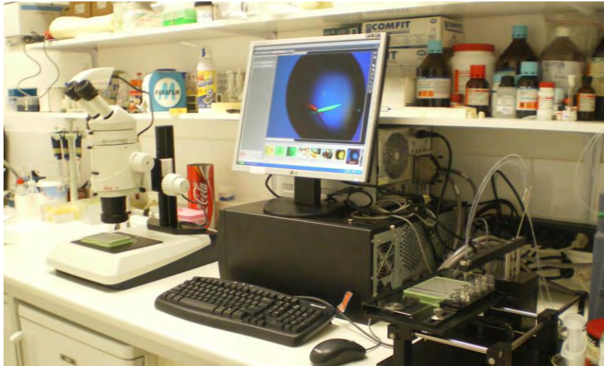
Εικόνα 20. Ρομποτικό μηχάνημα κρυσταλλώσεων OryxNano (Douglas Instruments) του εργαστηρίου Δομικής Βιολογίας και Χημείας, ΕΙΕ.
