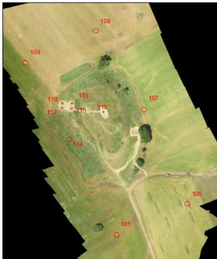
Εικόνα 5.2.3.3: Απεικόνιση των φωτοσταθερών και των σημείων ελέγχου
