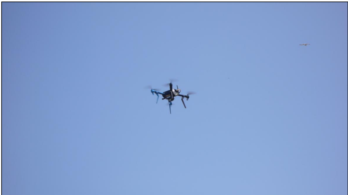
Εικόνα 5.2.3.4: Το τετρακόπτερο IRIS της 3DRobotics εν πτήση
