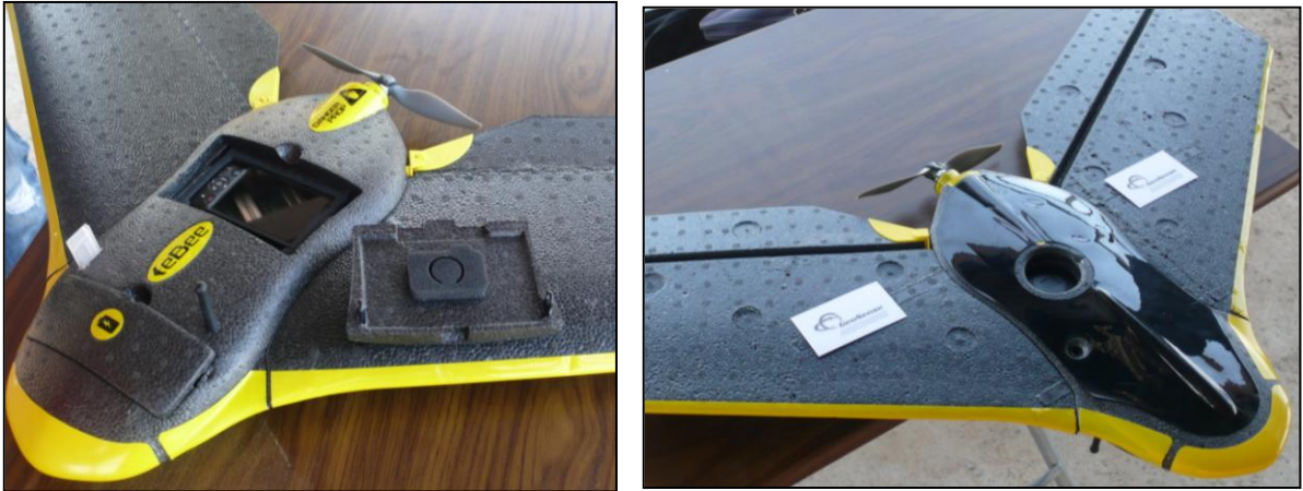
Εικόνα 5.2.4.1: Θέση αποθήκευσης φωτογραφικής μηχανής του eBee (πάνω και κάτω όψη)
