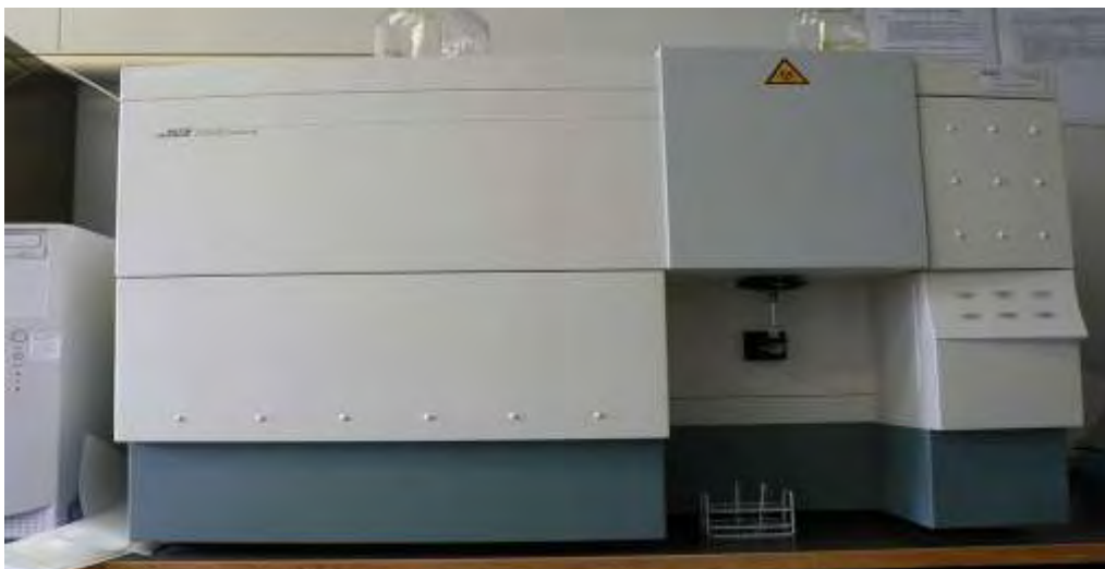
Εικόνα 31. Το μηχάνημα της κυτταρομετρίας ροής από την Becton-Dickinson
