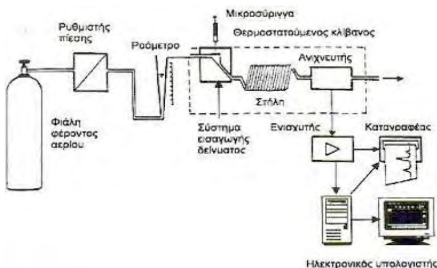
Εικόνα 14: Το φέρον αέριο (συνήθως N 2 , He, H 2 , Ar) από τη φιάλη υψηλής πίεσης, μέσα από ρυθμιστές παροχής, οδηγείται στη στήλη. Η εισαγωγή του δείγματος γίνεται με μικροσύριγγα στη βαλβίδα εισαγωγής του δείγματος στην κορυφή της στήλης. Τα συστατικά του δείγματος συμπαρασύρονται από το φέρον αέριο κατά μήκος της στήλης και διαχωρίζονται. Τα κλάσματα στη συνέχεια ανιχνεύονται στον ανιχνευτή και τα σήματα ανίχνευσης καταγράφονται από καταγραφικό. Σε ορισμένες περιπτώσεις, στη συνέχεια υπάρχει μια διάταξη, όπου συλλέγονται τα διάφορα κλάσματα και ένα ροόμετρο για τον έλεγχο της ταχύτητας ροής του φέροντος αερίου (Χατζηγιάννου, 2003).
