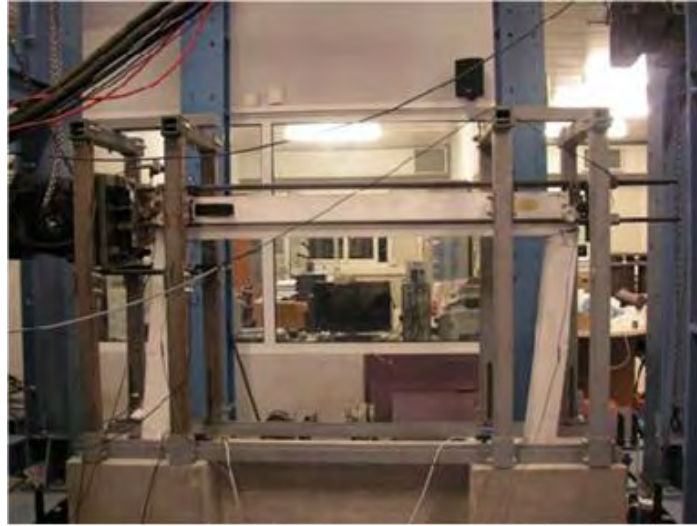
Σχήμα 3.1.7 : Εικόνα αστοχίας πλαισίου μετά το πέρας της δοκιμής (Περδικάρης, 2011)
