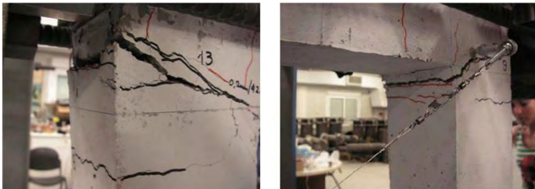
Σχήμα 3.1.8 : Μορφολογία ρηγμάτωσης κόμβου δοκού – υποστυλώματος (Περδικάρης, 2011)
