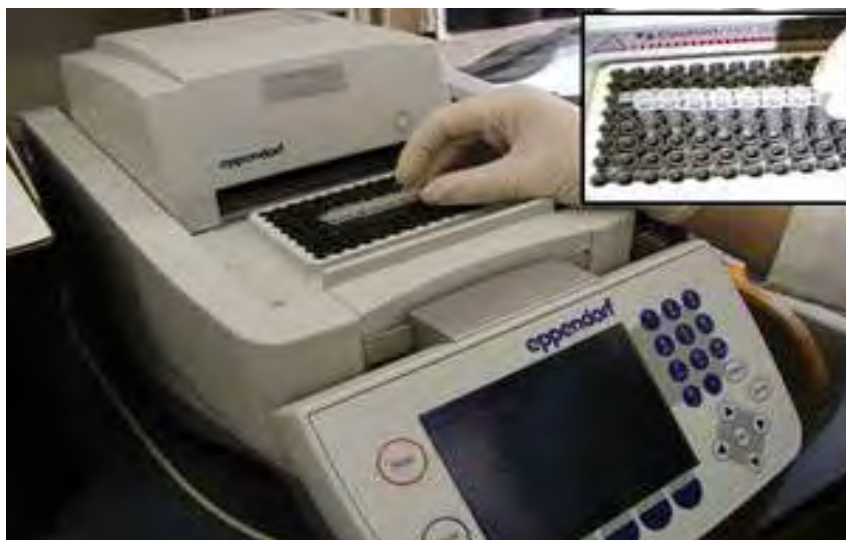
Εικόνα 7: Θερμοκυκλοτής. Μηχάνημα στο οποίο επιτελείται η τεχνική της PCR.
