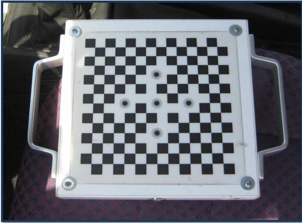
Εικόνα 6.10: Ειδική πλακέτα βαθμονόμησης καμερών
