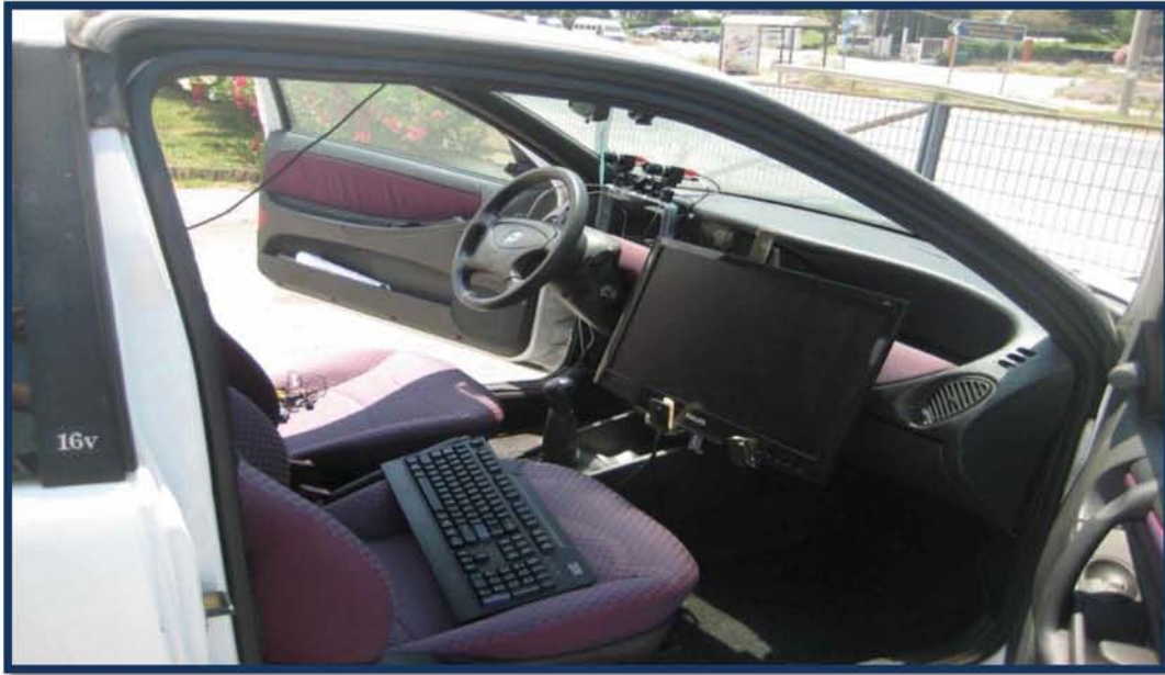
Εικόνα 6.11: Σύστημα παρακολούθησης και καταγραφής ματιάς και κεφαλής οδηγού Facelab
