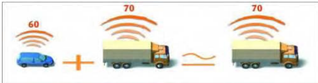
Εικόνα 1.6: Πρόσθεση δύο σταθμών ηχητικής πίεσης (πηγή: www.bruitparif.fr )
