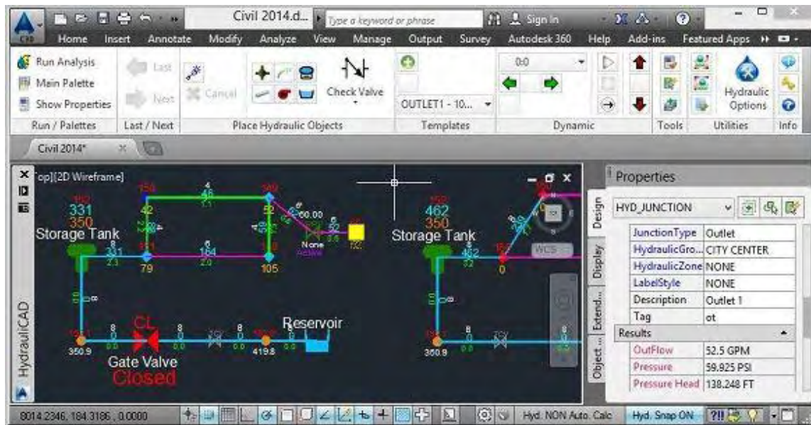
Εικόνα 32: Μοντελοποίηση δικτύου ύδρευσης σε περιβάλλον hydraulicCAD 2014 ( πηγή : http://hydraulicad.com/ )
