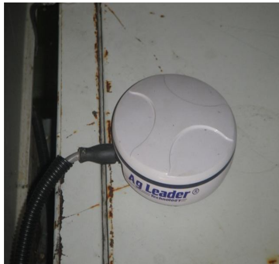
Σχήμα 4.3.1 Εγκατάσταση του GPS 1500 στην οροφή της καμπίνας.
