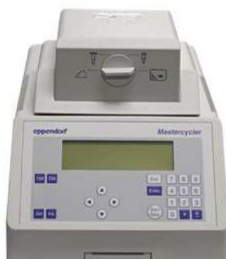
Εικ. 4: Θερμοκυκλοποιητής που χρησιμοποιείται για την αντίδραση PCR.
