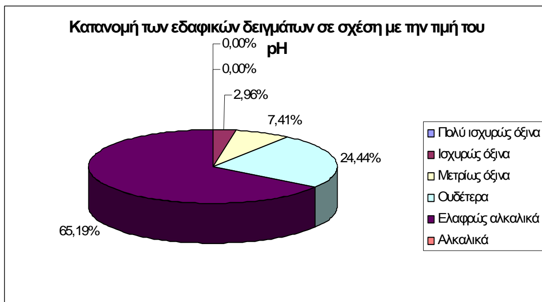
Σχήμα 3.1. Κατάταξη εδαφών της περιοχής Αλμυρού Ν. Μαγνησίας σε αναλογία με το pH του εδάφους
