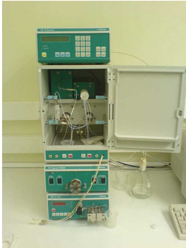
Εικόνα Π2 Το όργανο της ιοντικής χρωματογραφίας του Εργαστηρίου Εδαφολογίας του Πανεπιστημίου Θεσσαλίας.
