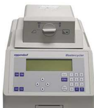
Εικόνα 16: Θερμοκυκλοποιητής που χρησιμοποιείται για την πραγματοποίηση των αντιδράσεων PCR.
