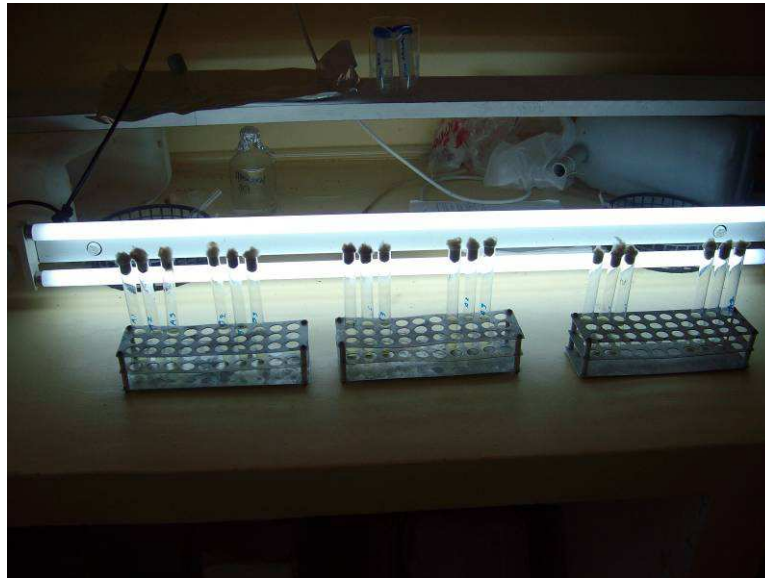
Εικόνα 7: Οι τριάδες των δοκιμαστικών σωλήνων που περιέχουν τα μικροφύκη Isochrysis galbana με τις διαφορετικές συγκεντρώσεις διφθοροβενζουρόνης, (Φωτογραφία Μαντζούκης Χρήστος).
