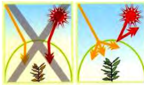
Εικόνα 5. Επίδραση της χρήσης των IR πρόσθετων στην κοντινή υπέρυθρη ακτινοβολία.
