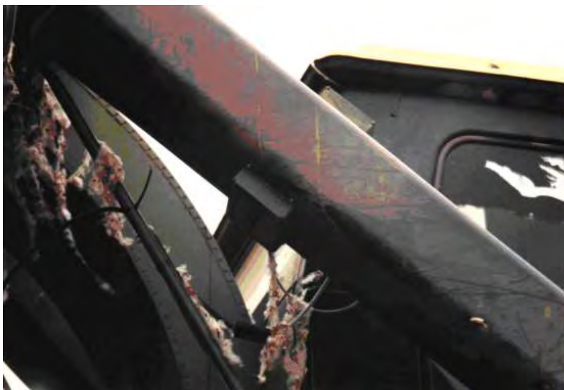
Σχήμα 19. Πομπός και δέκτης υπέρυθρων αισθητήρων που εγκαθίστανται στο σωλήνα μεταφοράς του βαμβακιού προς το καλάθι
