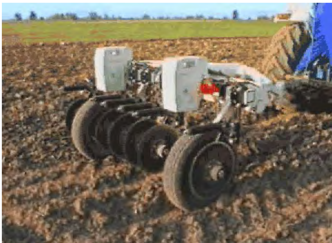
Σχήμα 22. Μέτρηση ηλεκτρικής αγωγιμότητας με το Veris® 3100
