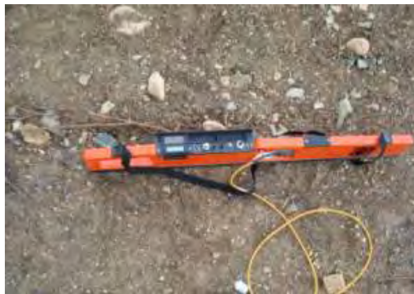
Σχήμα 1.2. Αισθητήρας μέτρησης ηλεκτρικής αγωγιμότητας EM-38
