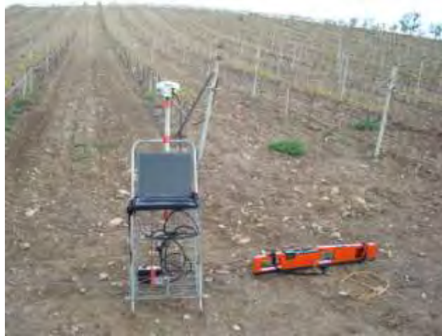
Σχήμα 3.9. Αισθητήρας ηλεκτρομαγνητικής επαγωγής EM 38 συνδεδεμένος με δέκτη GPS μέσω φορητού ηλεκτρονικού υπολογιστή
