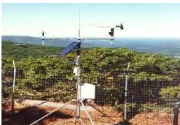
Σχήμα 1.7. Μετεωρολογικός κλωβός με εγκατεστημένο ασύρματο αισθητήρα μέτρησης της εδαφικής υγρασίας
