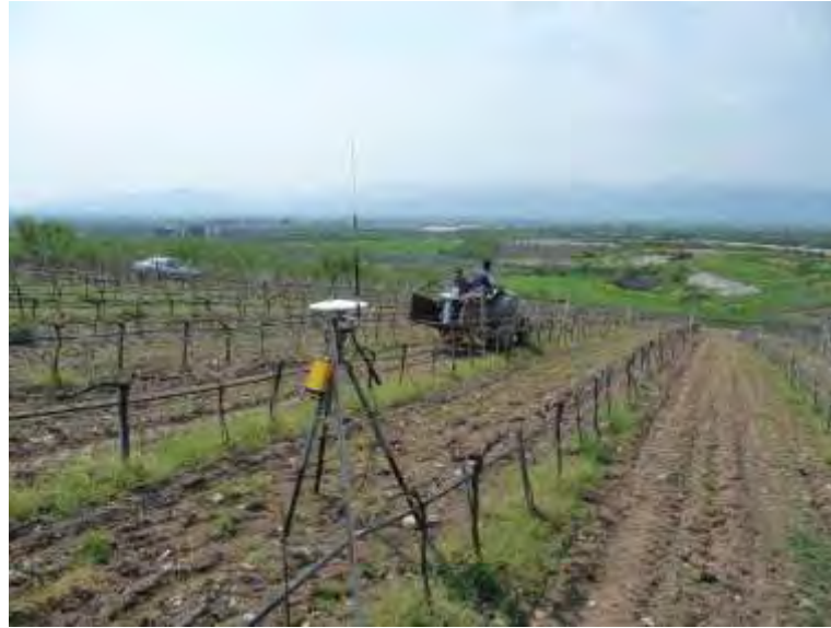
Σχήμα 3.6. Εγκατάσταση του RTK GPS στον αγρό
