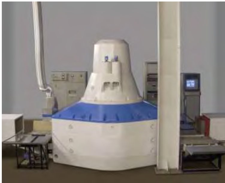
Εικόνα 25. Παραγωγή ακτινοβολίας για απεντόμωση.
