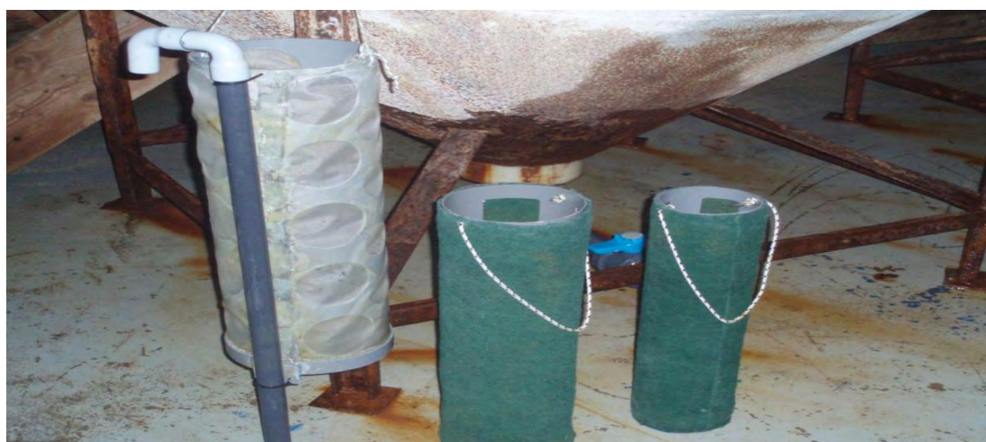
Εικόνα 5: Επιμέρους φίλτρα που αποτελούν τον αυτόματο καθαριστή ( matrioska ) (Πηγή: προσωπικό αρχείο συγγραφέα).
