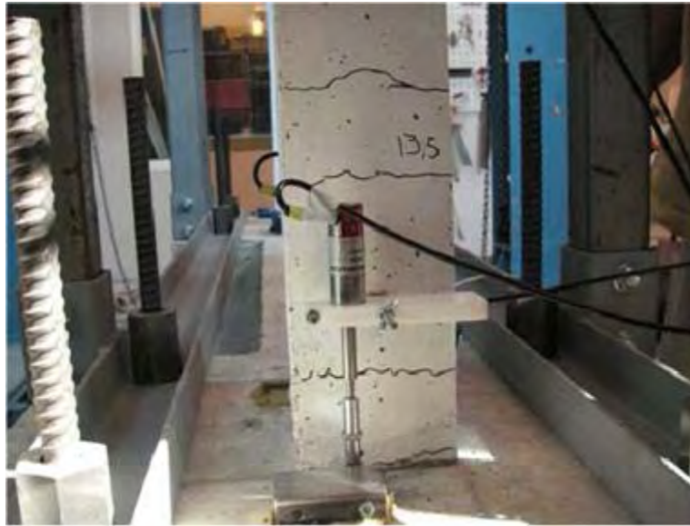
Σχήμα 3.1.9 : Ρηγμάτωση καθ' ύψος των υποστυλωμάτων
