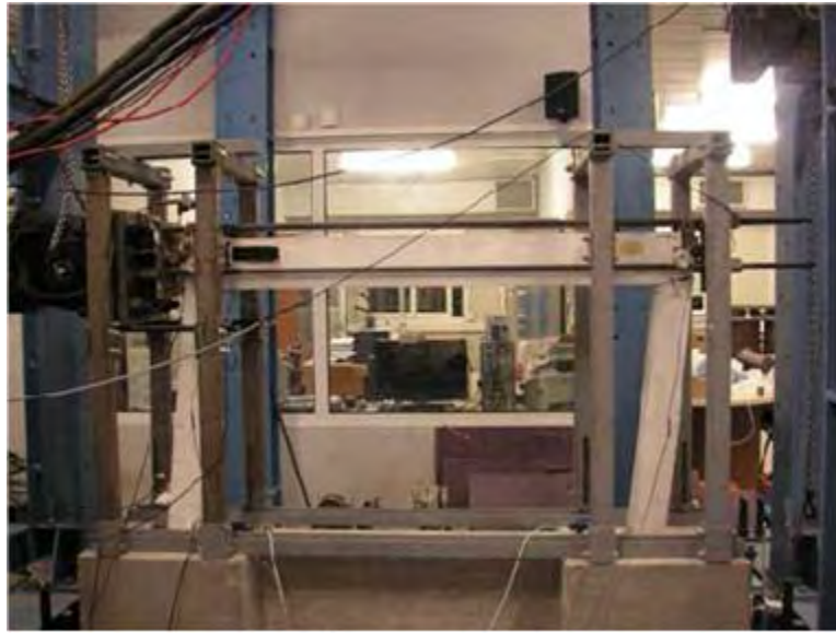
Σχήμα 3.1.7 : Εικόνα αστοχίας πλαισίου μετά το πέρας της δοκιμής
