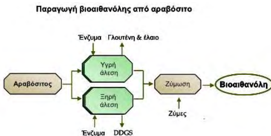
Σχήμα 2. Διαδικασία παραγωγής βιοαιθανόλης από αραβόσιτο
