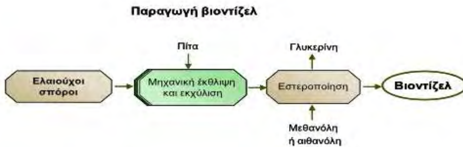
Σχήμα 3. Διαδικασία παραγωγής βιοντίζελ
