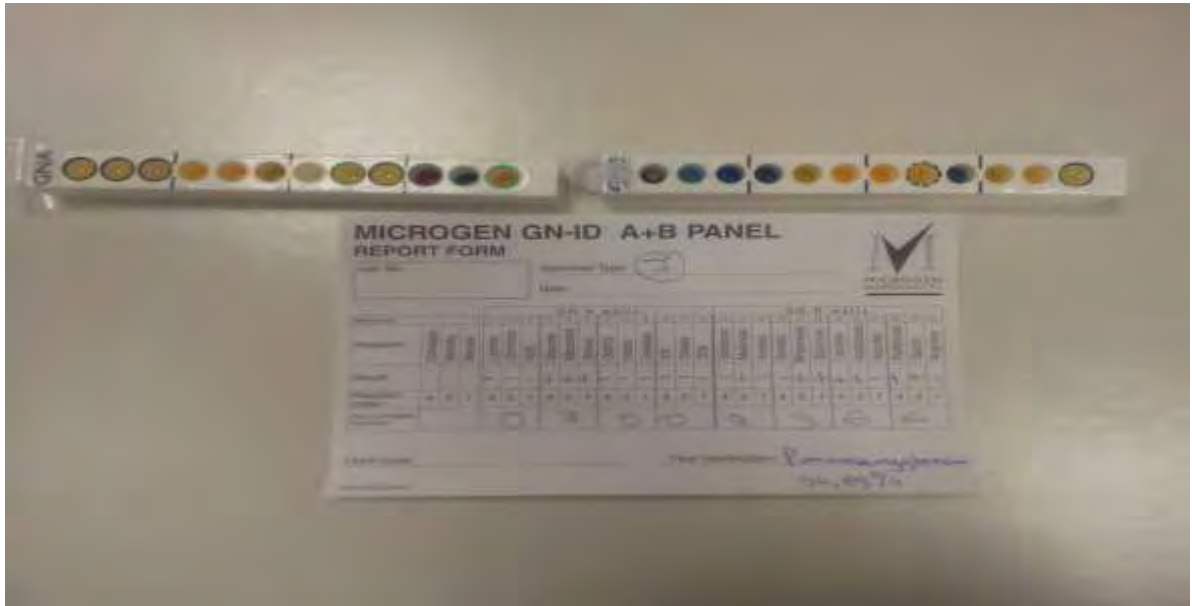
Εικόνα 11: MICROGEN GnA+GnB –ID SYSTEM μετά από την επώαση και πίνακας καταγραφής αριθμητικών δεδομένων.
