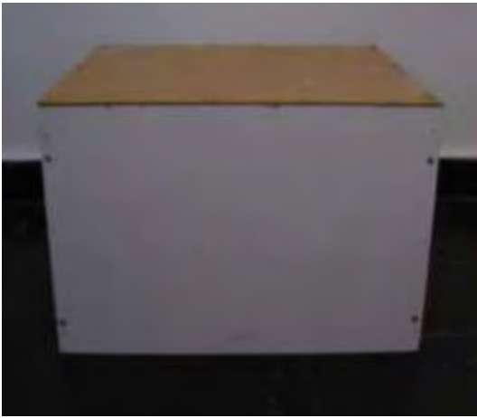
Σχήμα 4. Ένα ξύλινο κουτί διαστάσεων 35,9 (ύψος) \times 45 (πλάτος) \times 27,5 που χρησιμοποιήθηκε στην μέτρηση.
