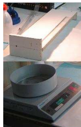
Εικόνα 5: Ζυγαριά και ιχθυόμετρο για τις μετρήσεις των ψαριών.
