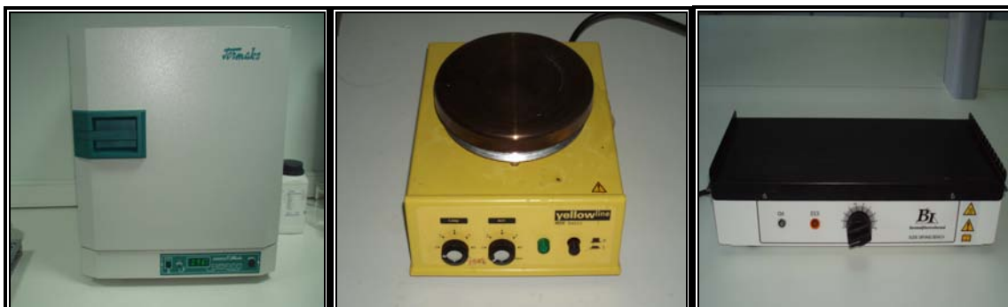
Εικόνα 2.9: Θερμαινόμενη πλάκα για την εξάτμιση του διαλύτη από τις αντικειμενοφόρους πλάκες.
