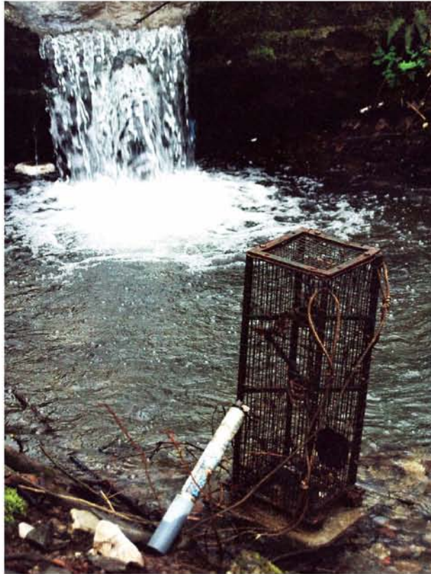
Εικόνα 34: Αυτόματη συσκευή μέτρησης ποιότητας νερού και προστατευτικός κλωβός.
