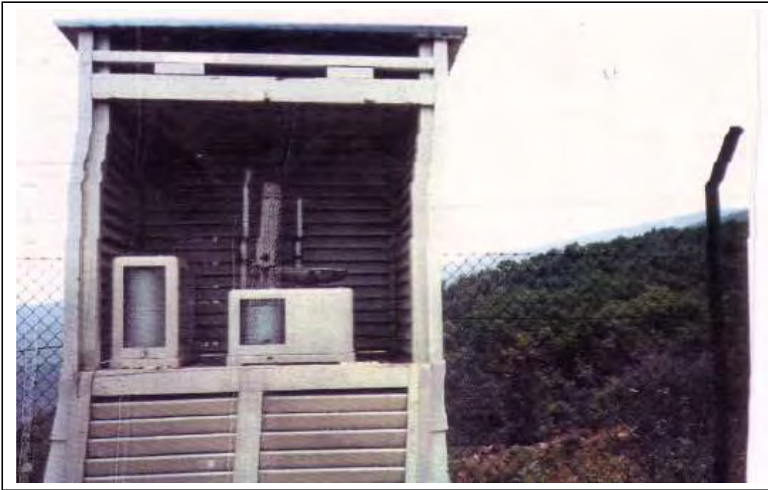
Εικόνα 7 : Μετεωρολογικός κλωβός στο Μ.Σ. Αγίας Τριάδας
