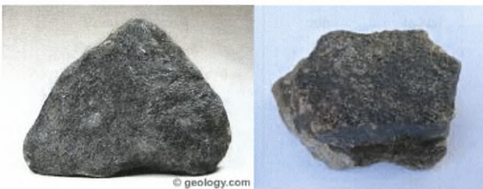
Εικόνα 3. γ. Χρωμίτης χημικού τύπου FeCr_2O_4 και Fe(Mg)Cr_2O_4 . (Ορυκτό τρισθενούς χρωμίου)
